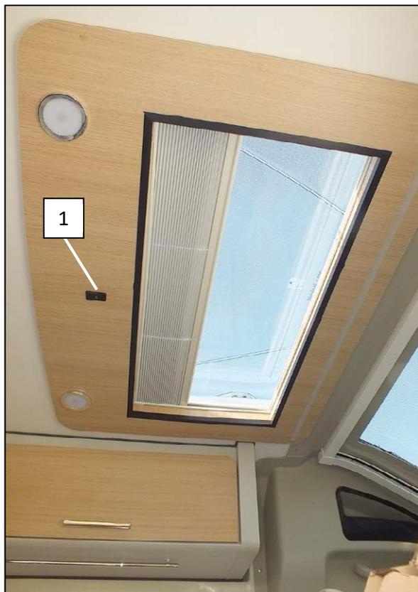
Optional kann das Fahrzeug mit einer elektrischen Dachhaube ausgestattet sein. Auch dieses Fenster ist ein Doppelfenster und besteht aus Acrylglas. Es ist mit einem manuellen Verdunkelungssystem ausgestattet. Die Dachhaube lässt sich per Knopfdruck (1) öffnen und schließen.
