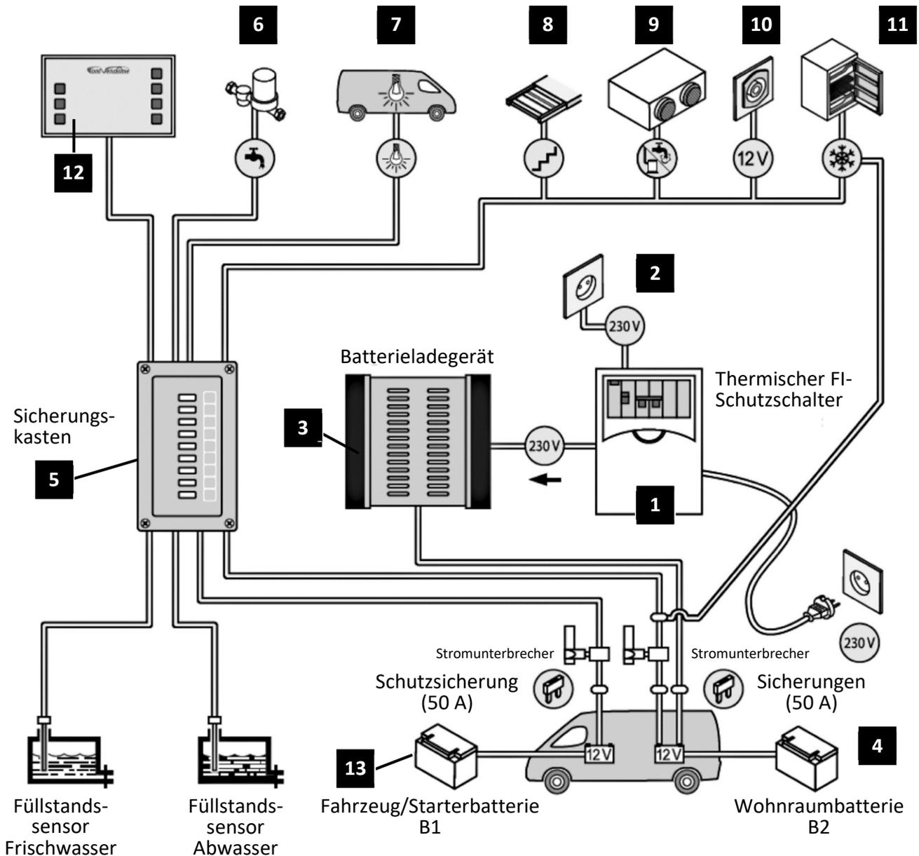
Die elektrische Anlage besteht aus einem 230 V- und einem 12 V-Stromkreis.
