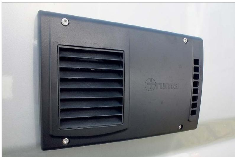
Abluft/Zuluft-Element an der Fahrzeugaußenseite
