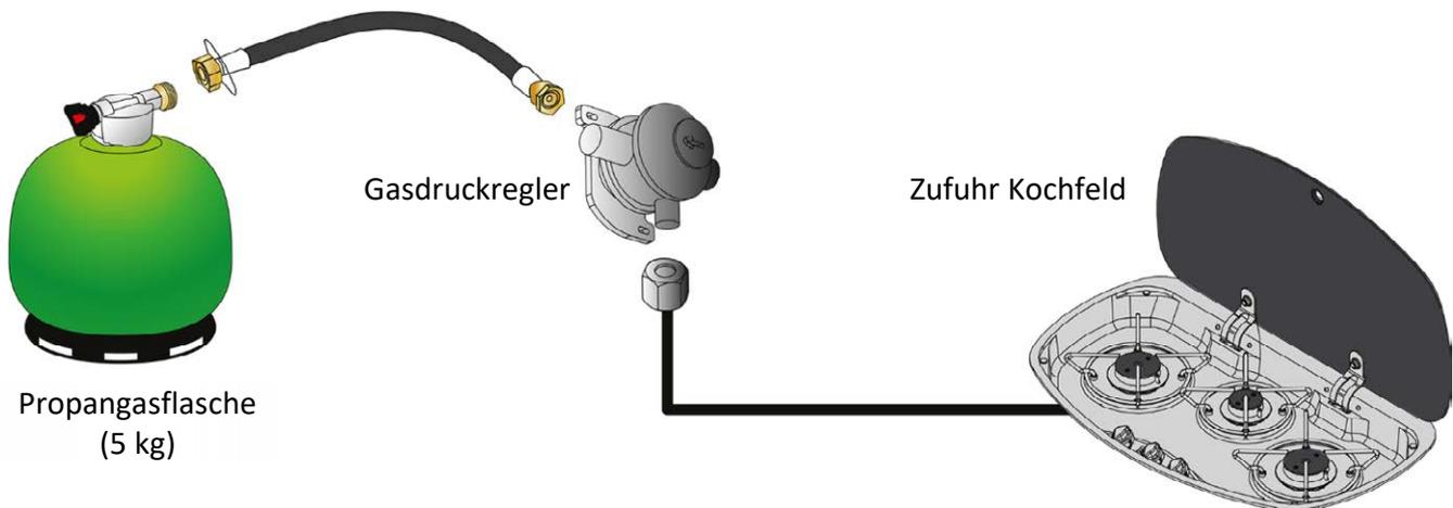
Die Gasanlage besteht aus der Gasflasche mit integriertem Sicherheitsventil (nicht im Lieferumfang enthalten), dem fest eingebauten Gasdruckregler und der Verbrauchsstelle, dem Gas-Kochfeld.
