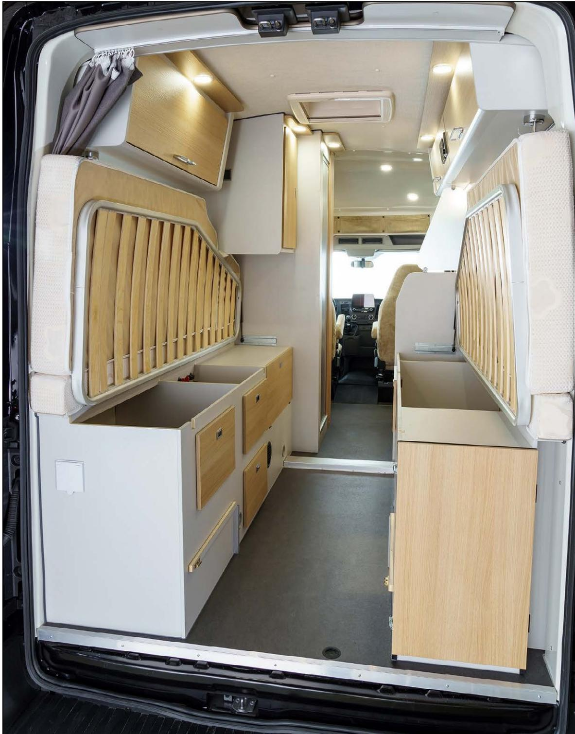
*Heckbett, Lattenroste hochgeklappt (Abb. beispielhaft)*
