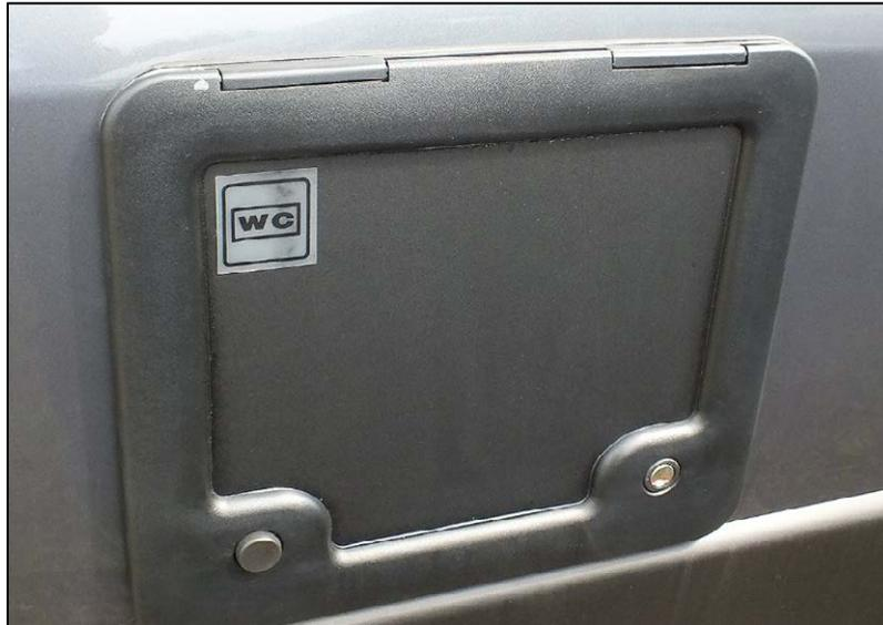
Zugang zur Kassette (= Serviceklappe WC)
