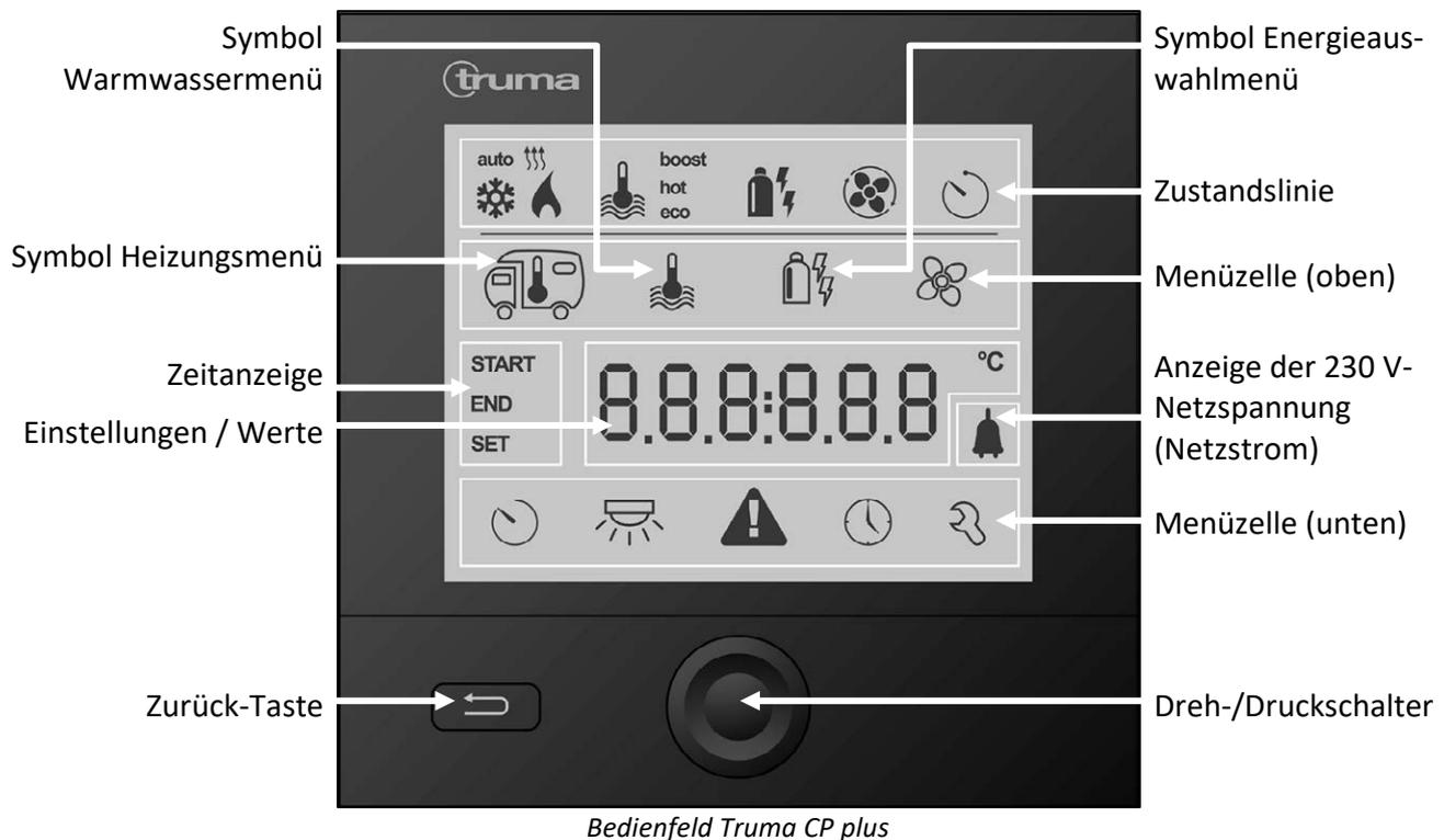
Mit dem Dreh-/Druckschalter können verschiedene Werte und Parameter ausgewählt, verändert und gespeichert werden. Die gewählten Menüpunkte blinken.
