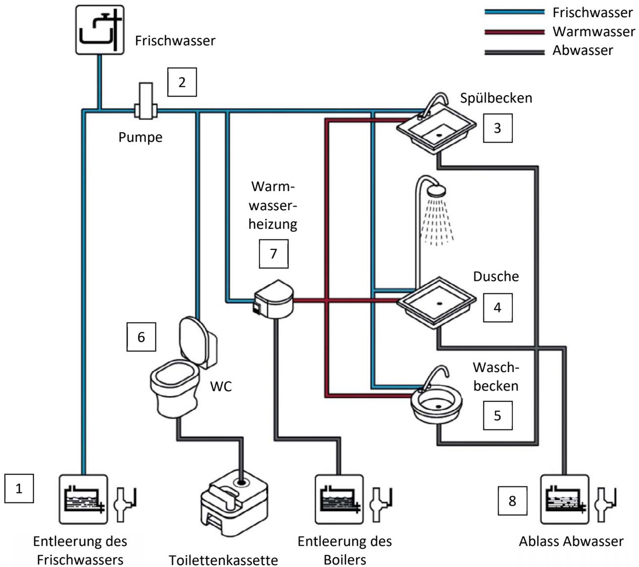
Die Frischwasseranlage besteht aus dem Frischwassertank (1), der Frischwasserpumpe (2), den Entnahmestellen Spülbecken (3), Dusche (4), Waschbecken (5), WC (6), dem Boiler der Heizung (7), der für das Warmwasser an den Entnahmestellen sorgt, sowie dem Abwassertank (8), in dem das entnommene Wasser gesammelt wird.
